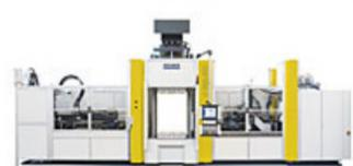
Die überarbeitete Version dieser Vertikalmaschine für große Spritzeinheiten steht nun durchgängig mit Schließkräften von 2.500 bis 8.000 kN zur Verfügung. Mit vollhydraulischer Schließeinheit, ergonomischer Bedienhöhe und mit weiter reduziertem Montageaufwand. [mehr »](#)
